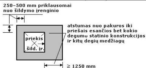
8 pav. Atstumo tarp šildymo įrenginio ir statinio konstrukcijos ir kitų degių medžiagų nustatymo principas
