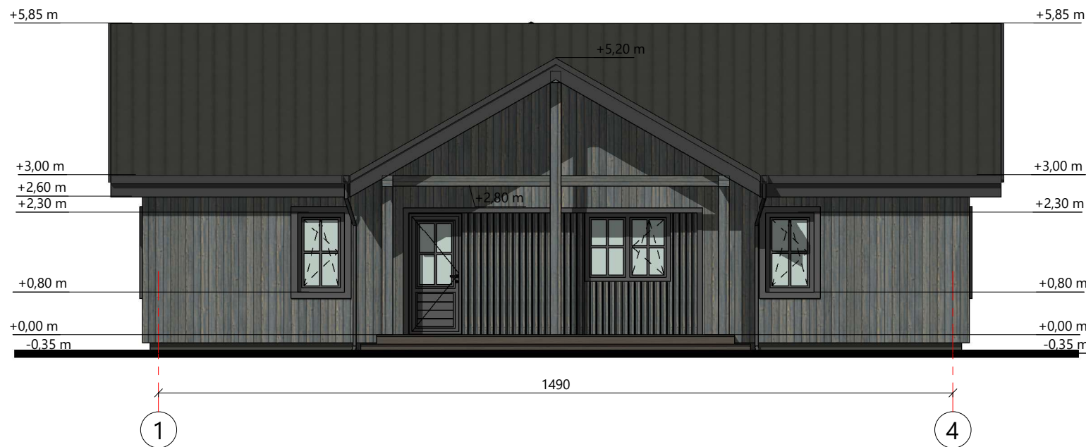
FASADAS TARP AŠIŲ 1-4 M 1 : 100
